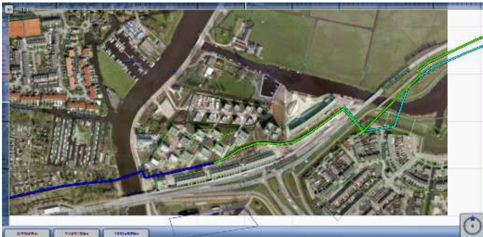
Figuur 4.2: Kilometer leiding behorende bij de maximale overschrijding van de FN-curve voor W-515-03 deel 2 van N.V. Nederlandse Gasunie
