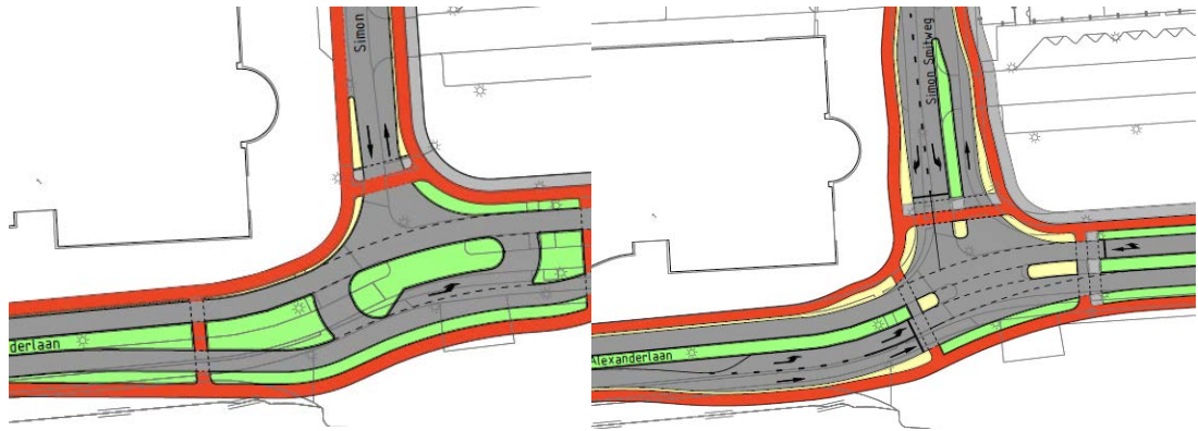
Fig 2. LARGAS kruispunt (links) of verkeerslichten geregeld kruispunt (rechts)
