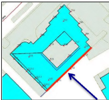
Afbeelding: gevels 2e verdieping zuidoost gevel en dak "doof" uitvoeren
