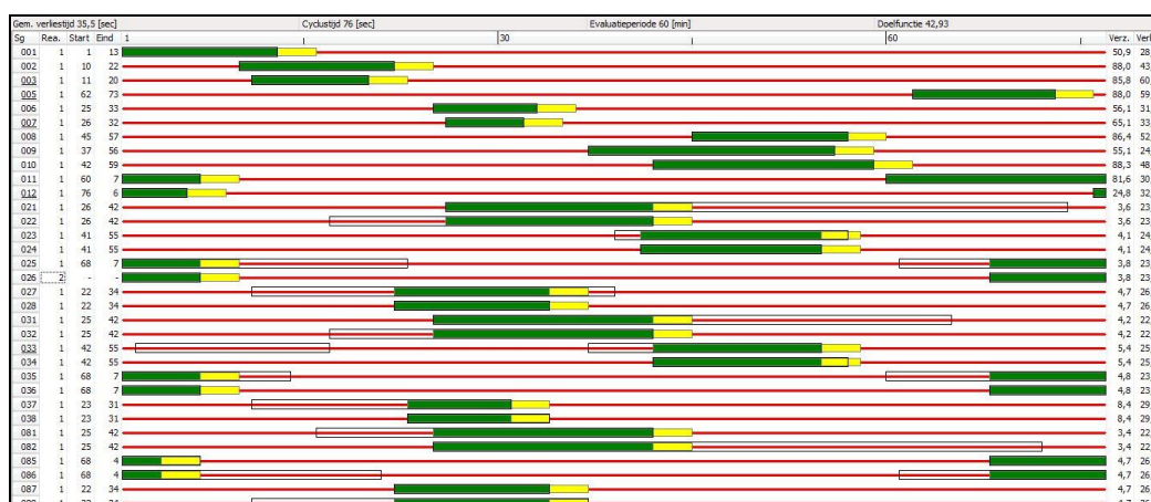
Figuur 17, Fasediagram en cyclustijd na optimalisatie VRI Persant Snoeweg - Engelendaal
